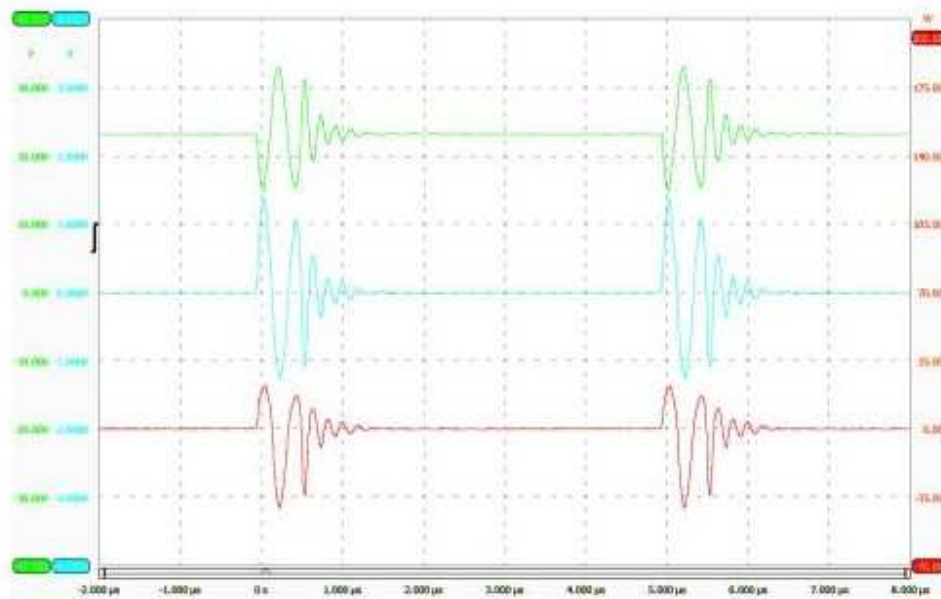
Figura 9: Señales vs. tiempo de voltaje de entrada (verde), corriente (azul-verde) y energía (rojo).
